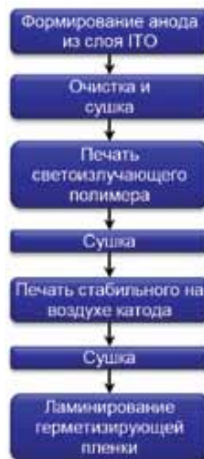
Рис. 16 Схема процесса производства гибкого печатного OLED экрана. Источник: J. Devin MacKenzie. Flexible OLEDs: print-based manufacturing, devices and applications. Printed Electronics USA, 2010
