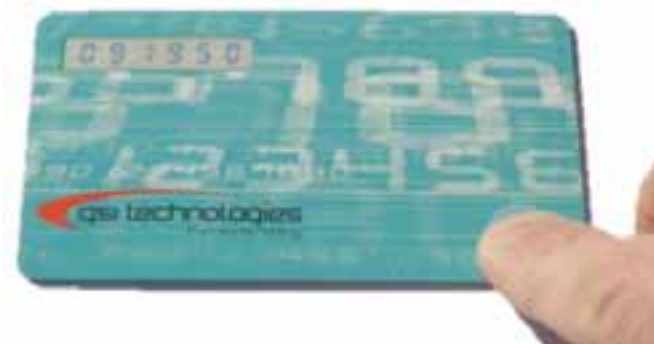
Рис. 14 Фотография кредитной карты со встроенным гибким печатным экраном для отображения одноразовых паролей. Источник: G. Smith. How printed electronics enable one-time passcode cards, 2011
