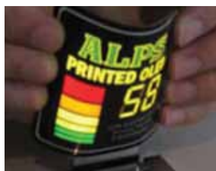
Рис. 17 Полностью напечатанный экран для отображения числовых данных и пиктограмм. Источник: Add-Vision
