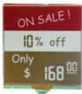
Рис. 8 Пример электрофоретического экрана с тремя цветовыми областями. Источник SiPix
