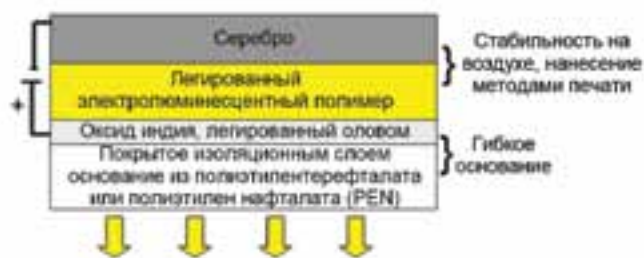
Рис. 15 Структура гибкого печатного OLED экрана. Источник: Add-Vision
